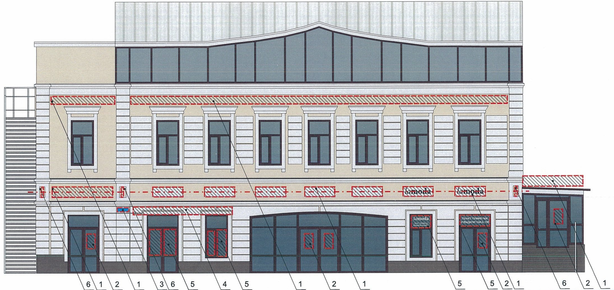
Схема крепления конструкций к фасаду
