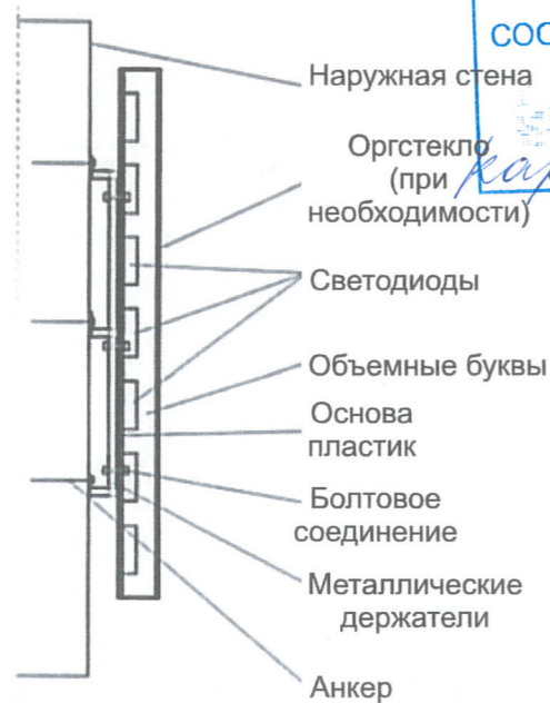
Схема крепления вывески
