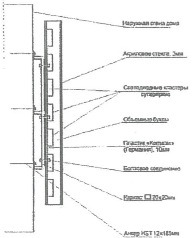
Схема крепления объемных букв к фасаду
