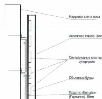
Схема крепления конструкции к фасаду
