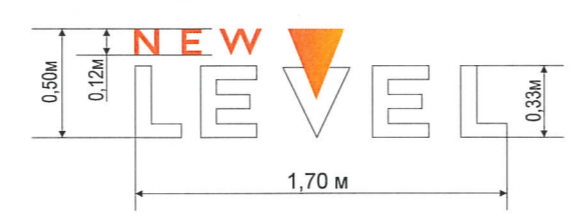
1. размещение вывесок в виде объемных букв (1) - симметрично относительно оконных проемов и оси размещения объектов городской информации. Вывеска (конструкция из отдельных букв)
