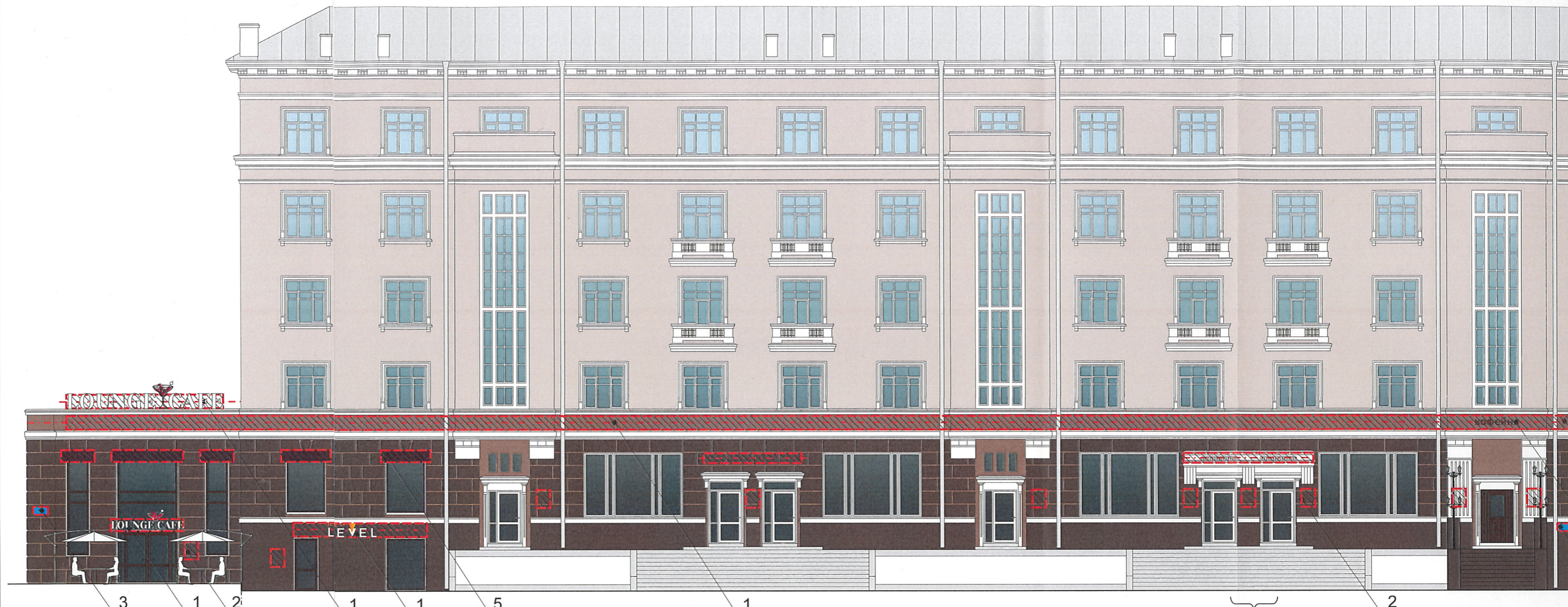
1. размещение вывесок в виде объемных букв (1) - симметрично относительно оконных проемов и оси размещения объектов городской информации. Вывеска (конструкция из отдельных букв)
