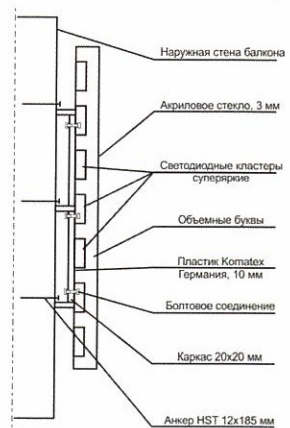
Схема креплений конструкций к балкону
