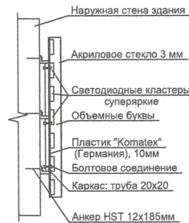
Схема крепления конструкций к фасаду
