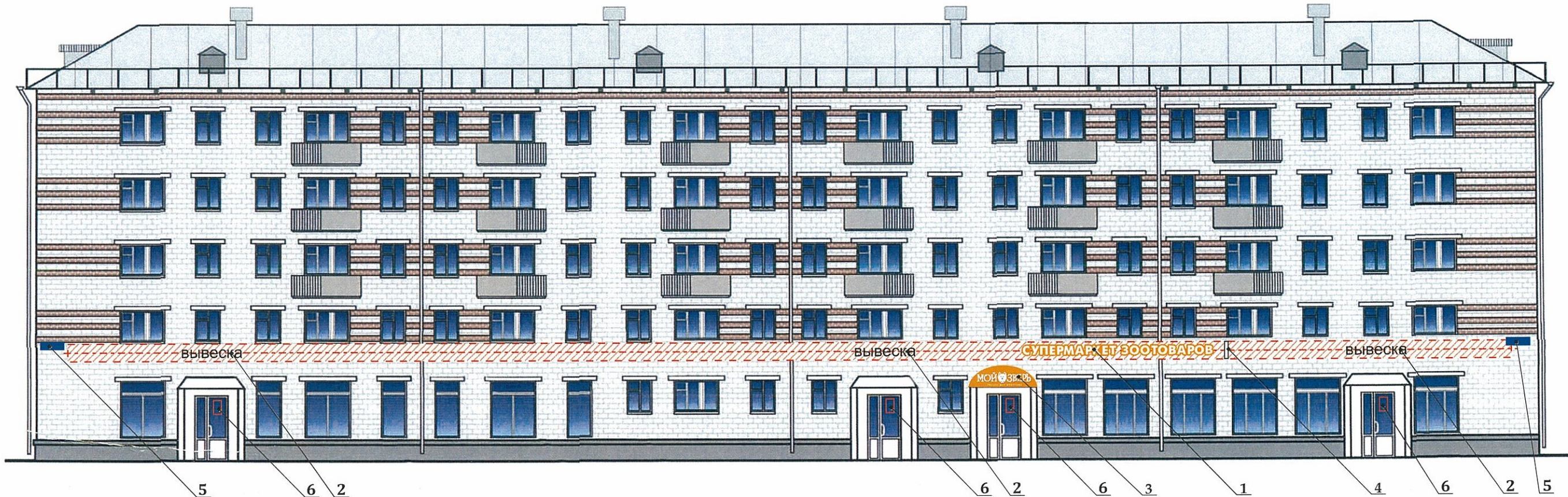
Схема крепления фриза с объемными световыми буквами
