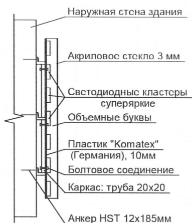
Схема крепления конструкций к фасаду
