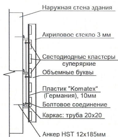
Схема крепления конструкций к фасаду
