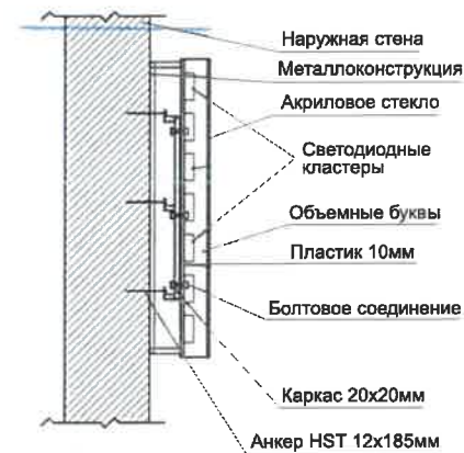
Схема крепления конструкций к фасаду
