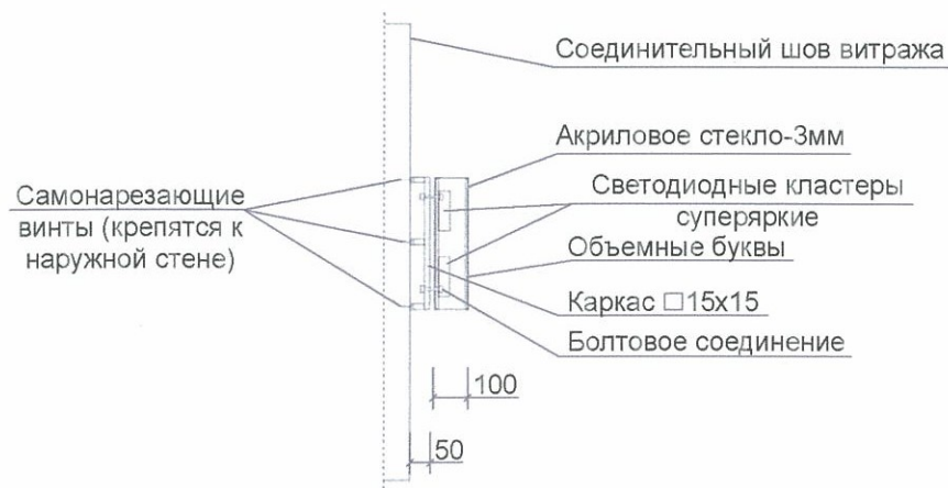
Схема крепления конструкции к фасаду
