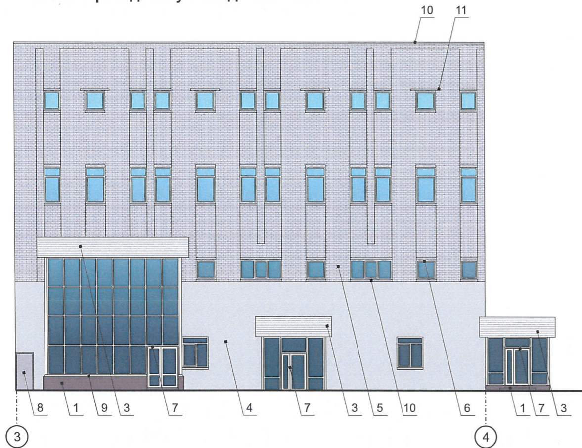
Фрагмент 2 главного фасада по ул.Солдатова осях 3-4
