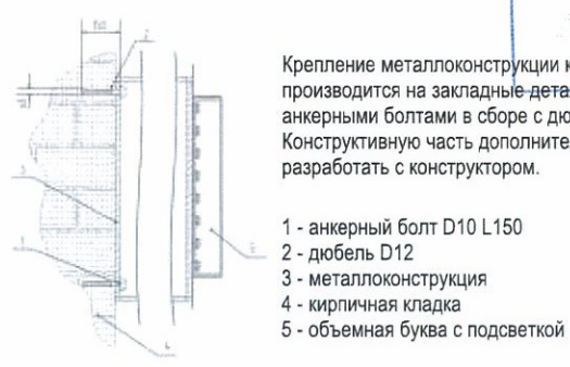
Пример крепления вывески к стене здания
