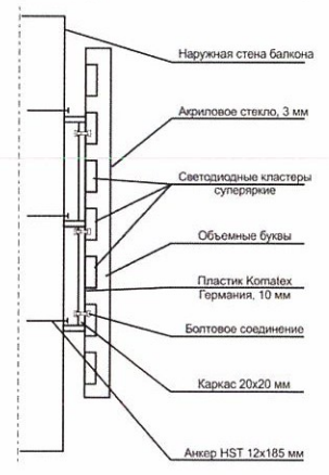
Схема креплений конструкций к балкону
