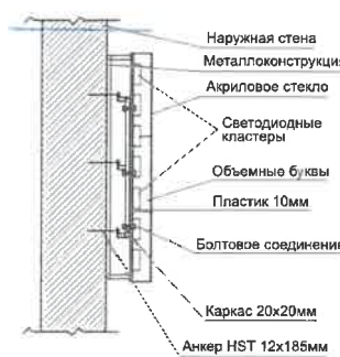
Пример крепления вывески к стене здания
