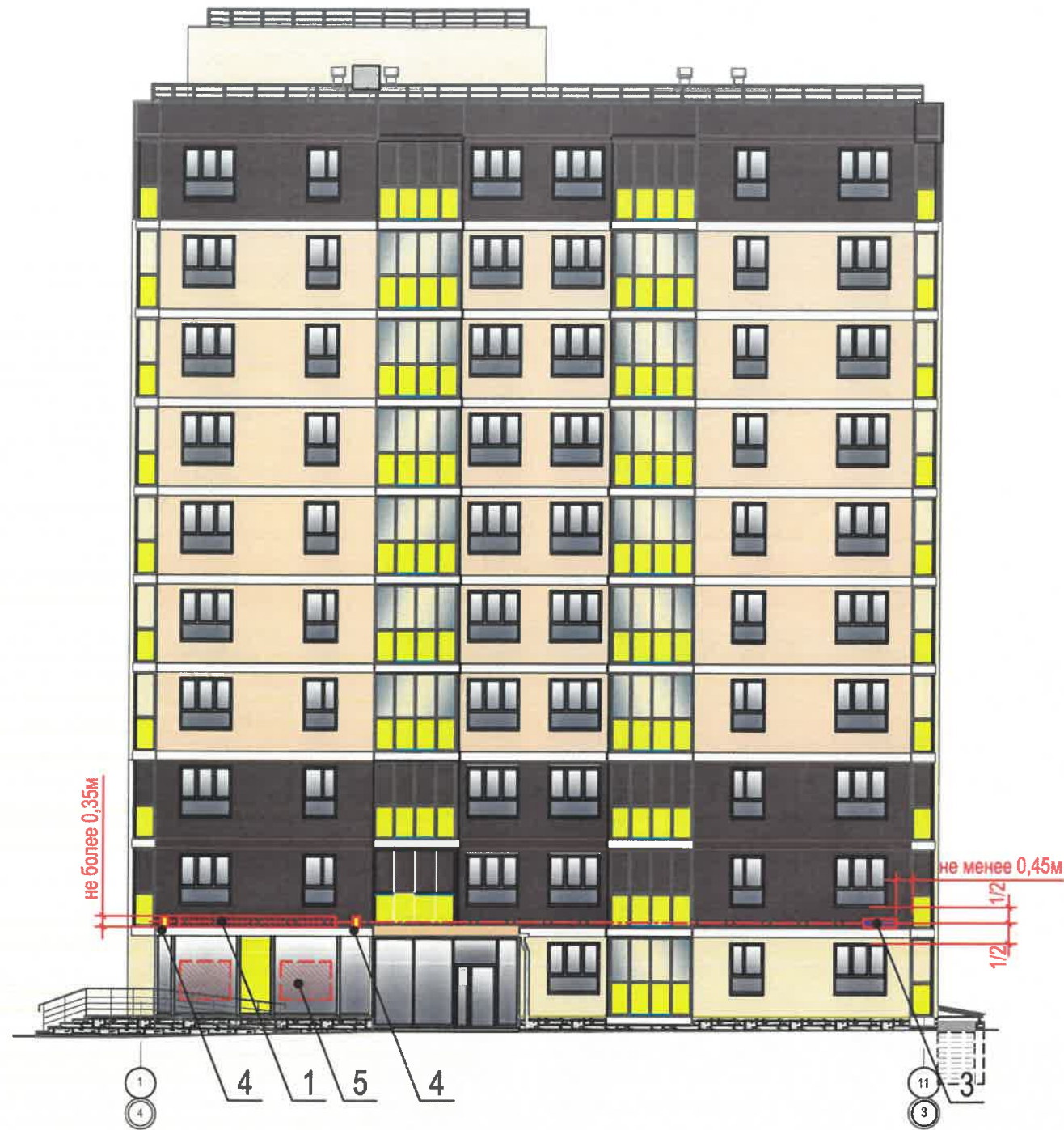
Схема компоновки объемных букв и/или логотипов, знаков относительно оси и места допустимого размещения объектов городской информации (Стандартные вывески)
