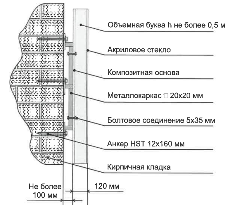
Схема крепления объемной буквы к фасаду на металлокаркасе (направляющих)
