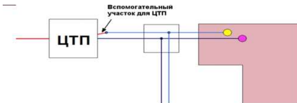
Рисунок 5 – Подключение трубопровода ГВС
