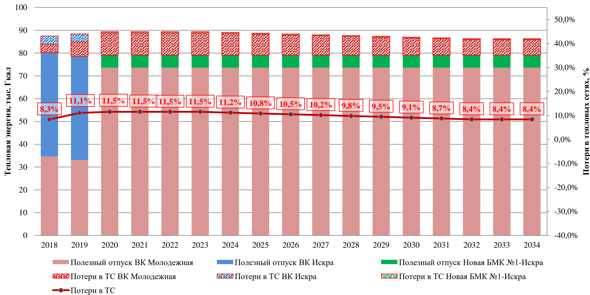
Рисунок 24 – Структура отпуска тепловой энергии ВК Искра - ВК Молодежный на период разработки Схемы
