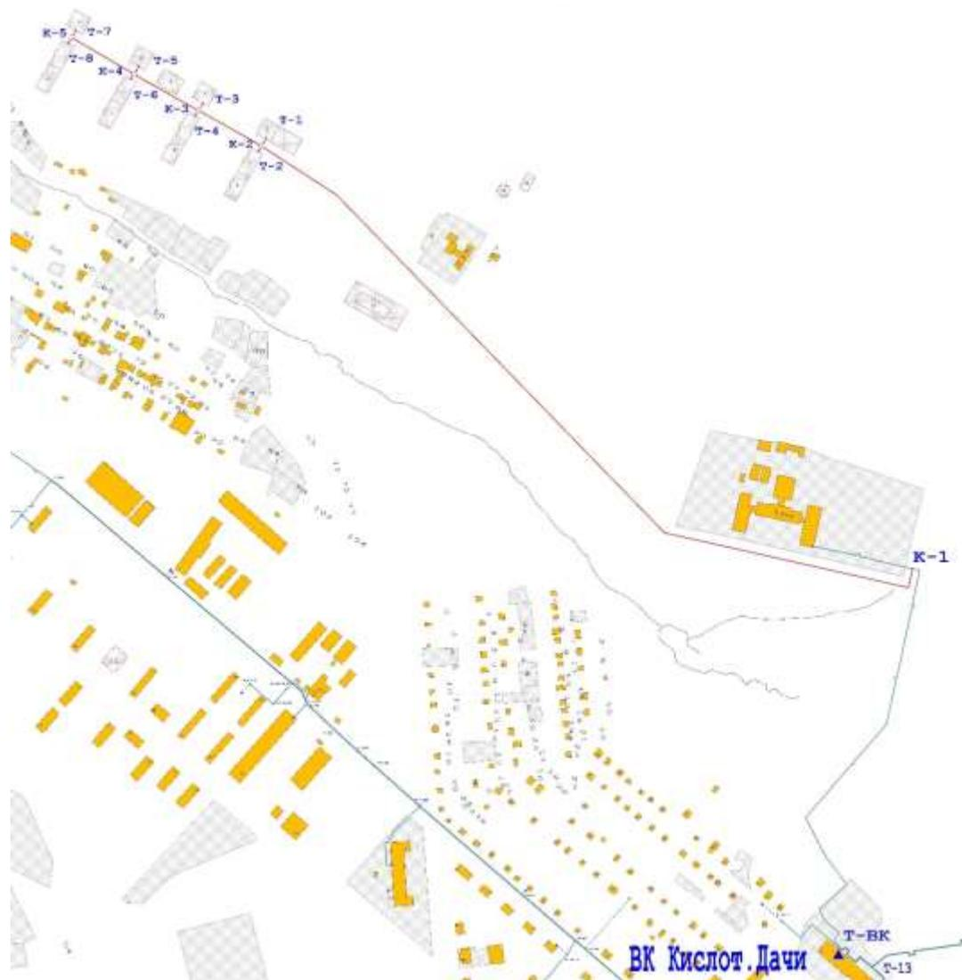
**Рисунок 3 – Ситуационный план развития системы теплоснабжения «комплекса многоквартирных жилых домов по ул. Веденева, 28.»**
