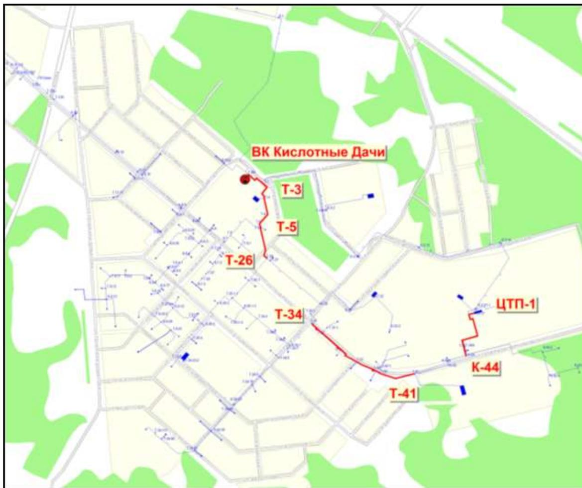
**Рисунок 16 - Трассировка магистралей от котельной Кислотные Дачи ООО «ПСК», подлежащих перекладке**
