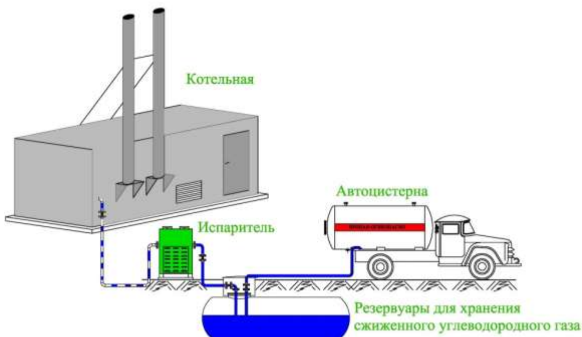
Рисунок 55 – Схема топливоснабжения котельной с использованием СУГ в качестве основного топлива
