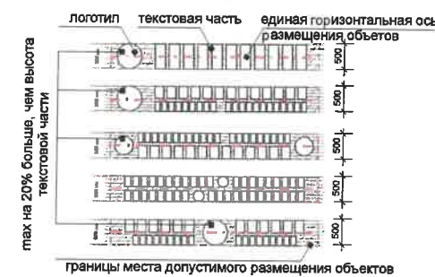
Схемы компоновки объемных букв или логотипов, знаков относительно оси размещения объектов городской информации
