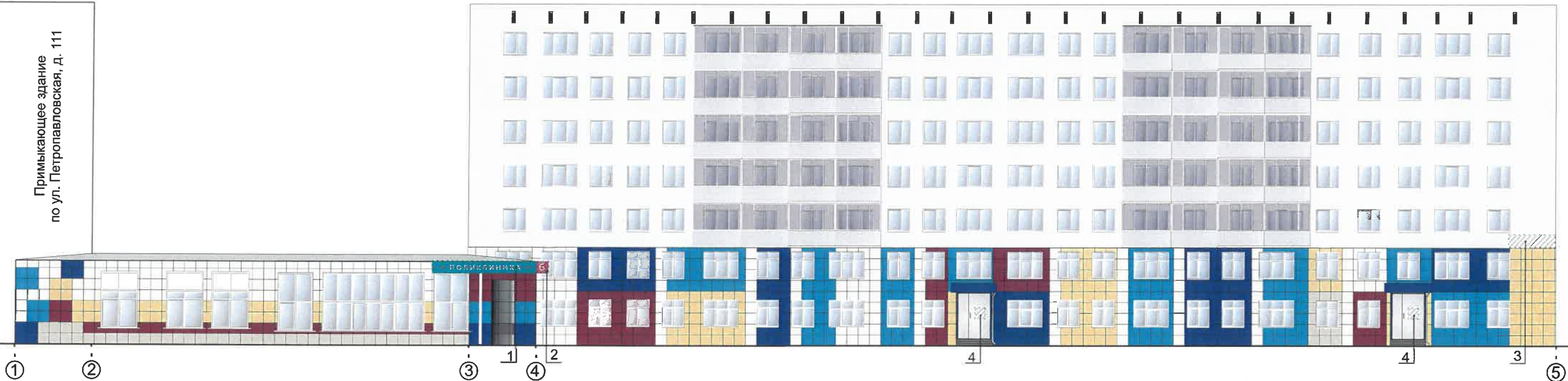
Схема компоновки объемных букв и/или логотипов, знаков относительно единой горизонтальной оси размещения средств размещения информации, рекламных конструкций
