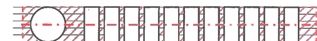
Схема компоновки объемных букв и/или логотипов, знаков относительно оси размещения средств размещения информации
