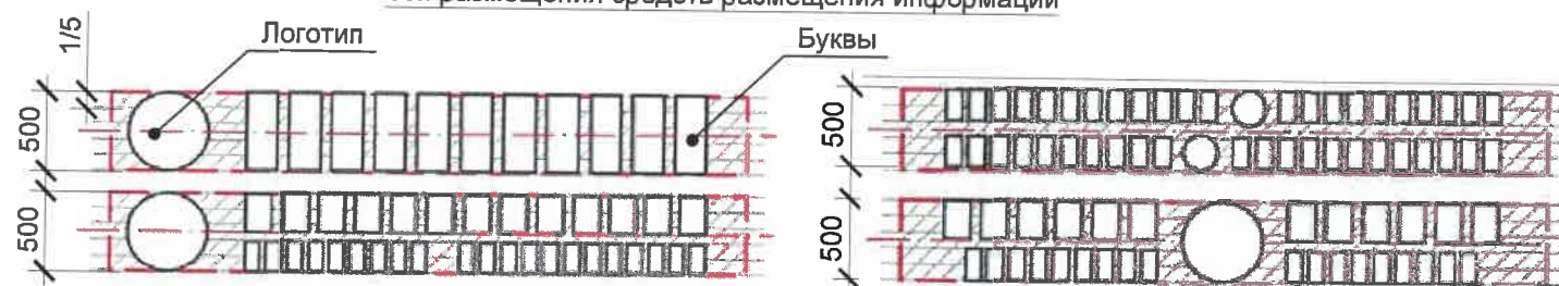
Схема компоновки объемных букв и/или логотипов, знаков относительно оси размещения средств размещения информации
