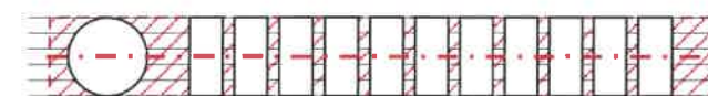
Схема компоновки объемных букв и/или логотипов, знаков относительно оси размещения средств размещения информации
