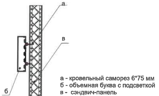
Схема крепления вывески к фасаду из сэндвич-панелей
