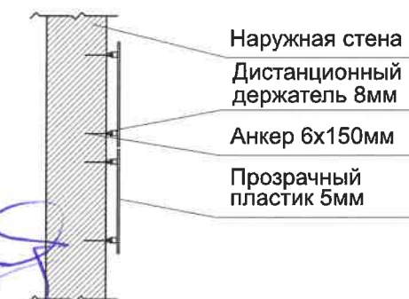
Узел крепления средств размещения информации, рекламных конструкций
