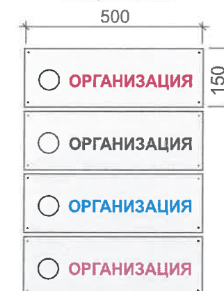
Узел крепления средств размещения информации, рекламных конструкций
