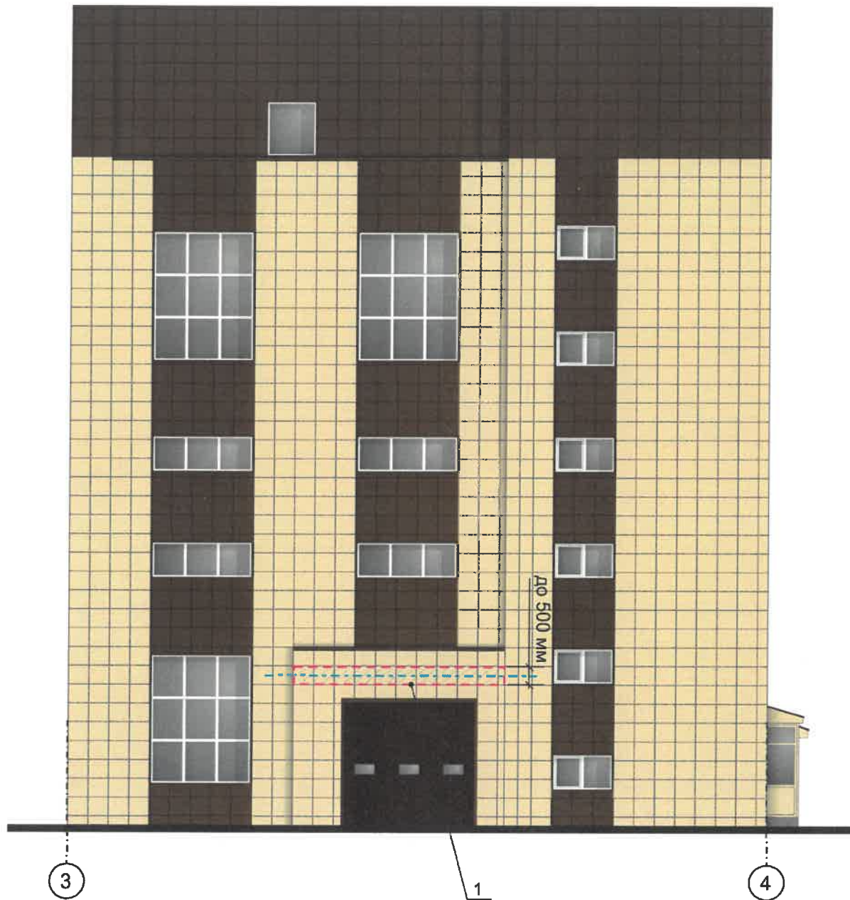
Схемы компоновки объемных букв и/или логотипов, относительно оси и места размещения средств размещения информации
