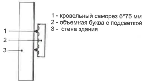
Схема крепления вывески к фасаду здания
