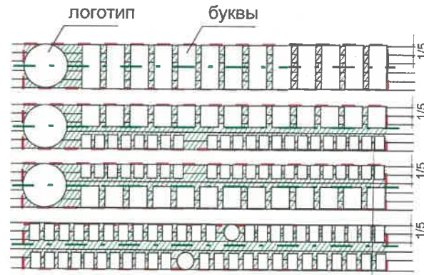
Схема компоновки объемных букв и/или логотипов, знаков относительно оси и места допустимого размещения средств информации, рекламных конструкций
