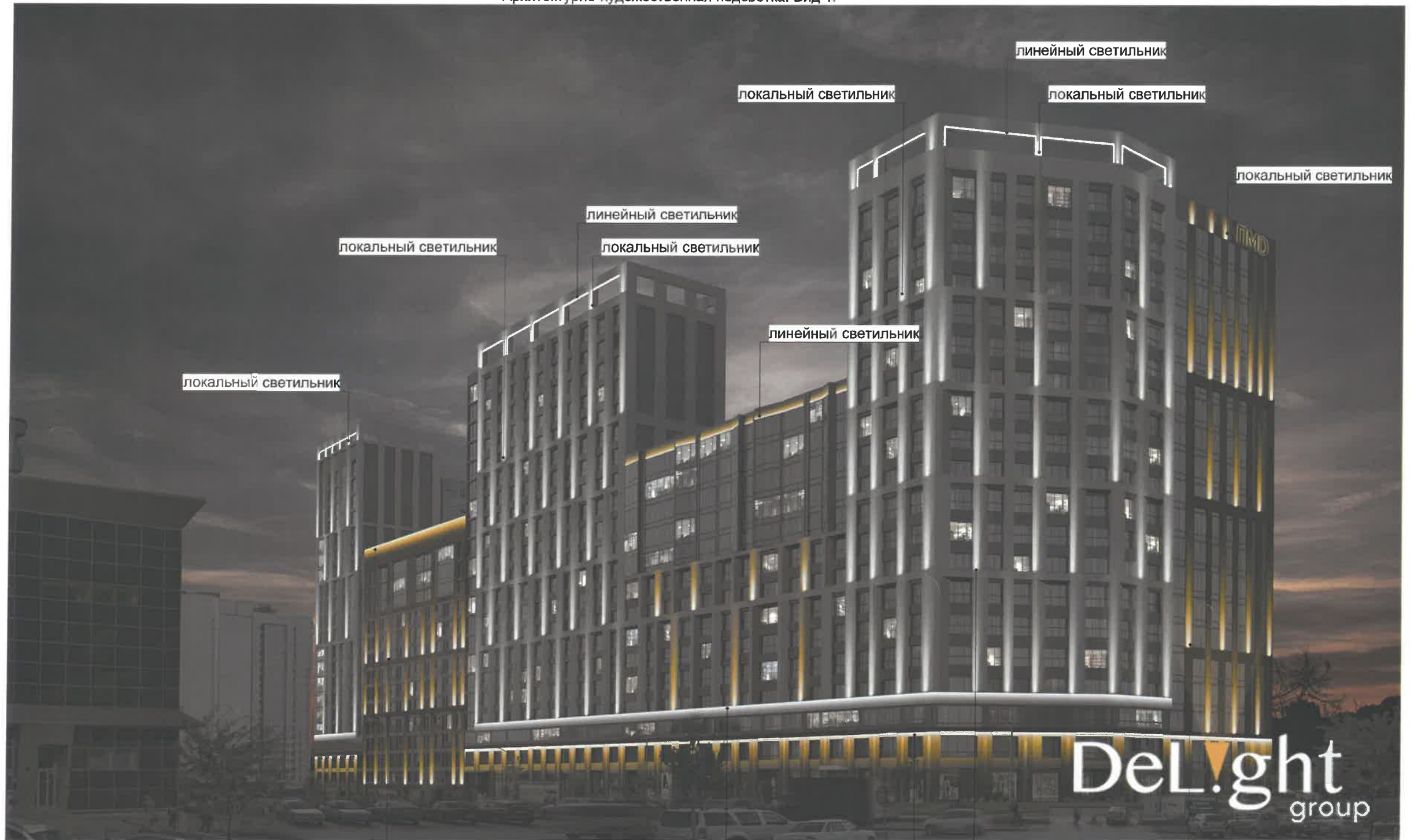
линейный светильник локальный светильник линейный светильник линейный светильник локальный светильник локальный светильник
