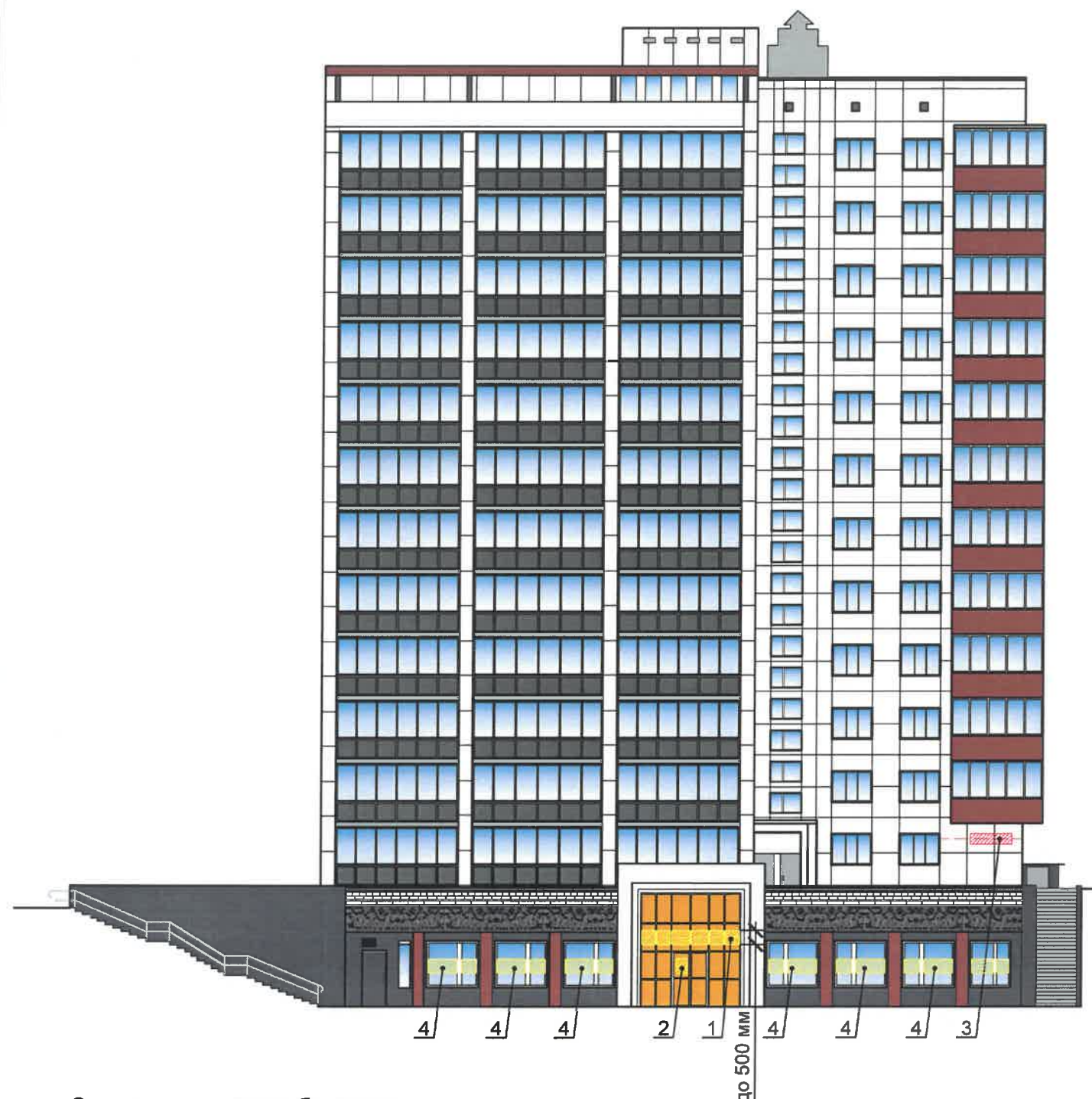
Схема компоновки объемных букв и/или логотипов, относительно оси и места размещения средств размещения информации
