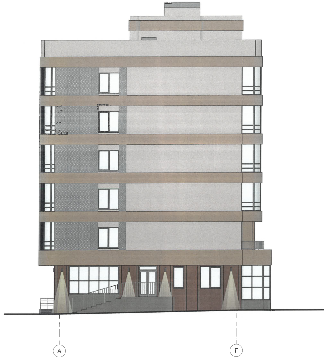
Боковой фасад (в осях А-Г)
