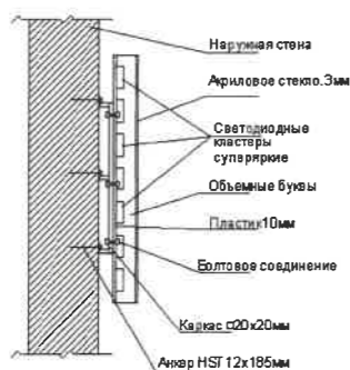
Узел крепления средств размещения информации
