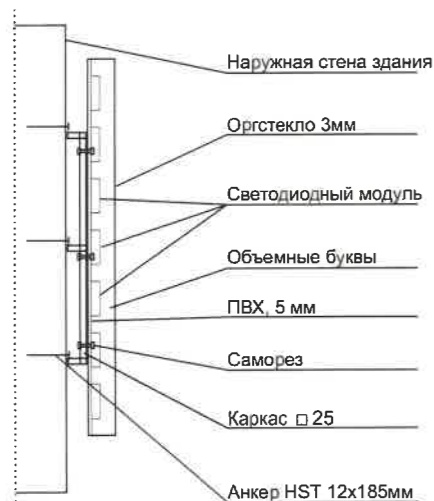
Схема крепления конструкций к фасаду
