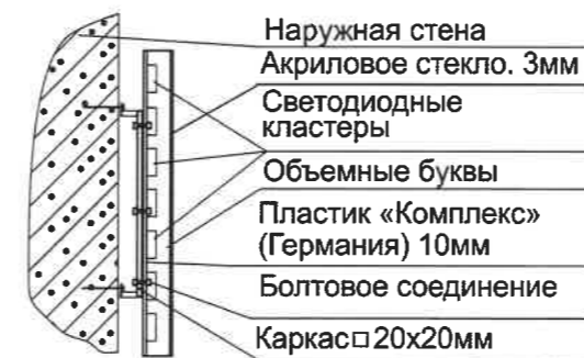
Схема крепления вывески 1
