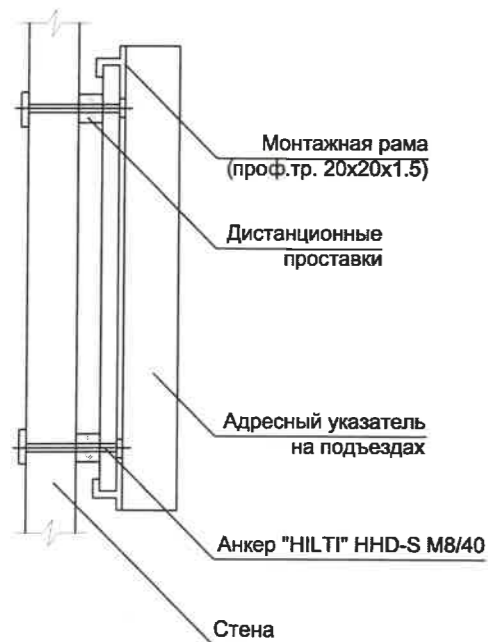
Узел крепления средств размещения информации
