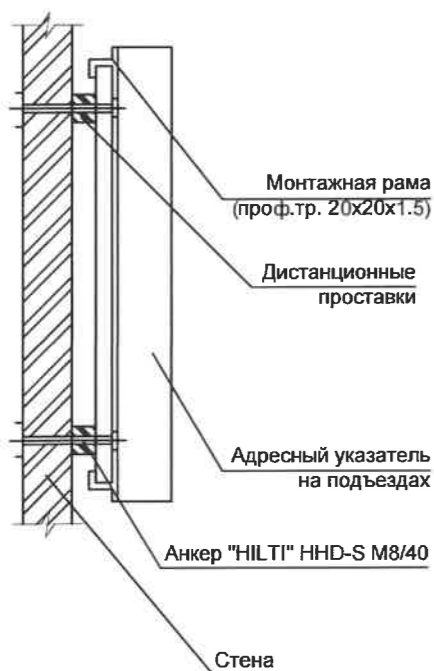
Узел крепления средств размещения информации
