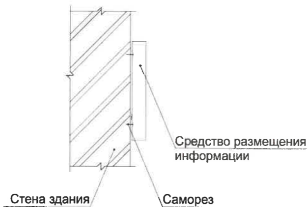
Схема крепления средств размещения информации
