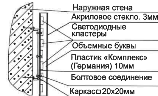
Схема крепления вывески 1
