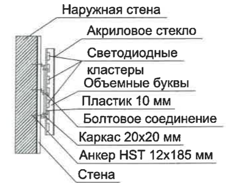
Узел крепления средств размещения информации (поз. 1)
