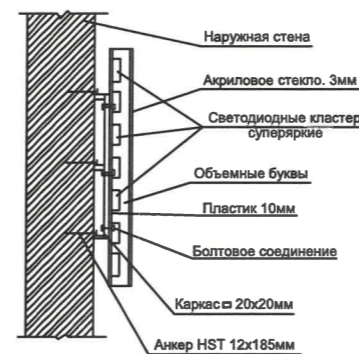
Узел крепления средств размещения информации
