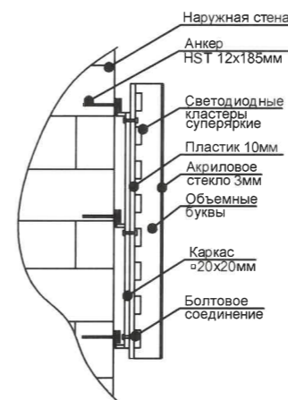
Узел крепления средств размещения информации
