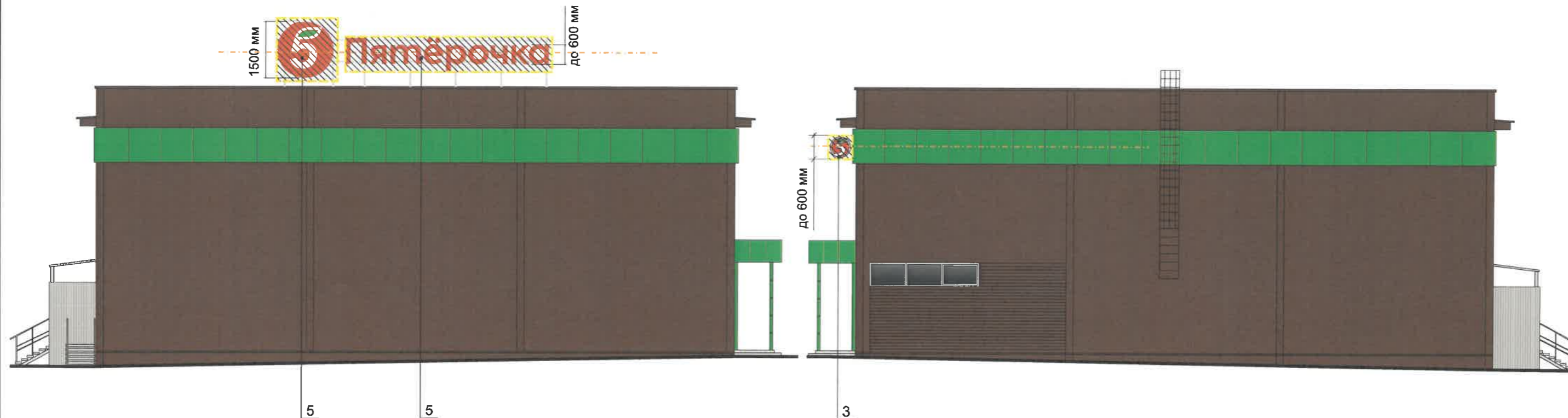
Схема компоновки объемных букв и/или логотипов, относительно оси и места размещения средств размещения информации, поз.1
