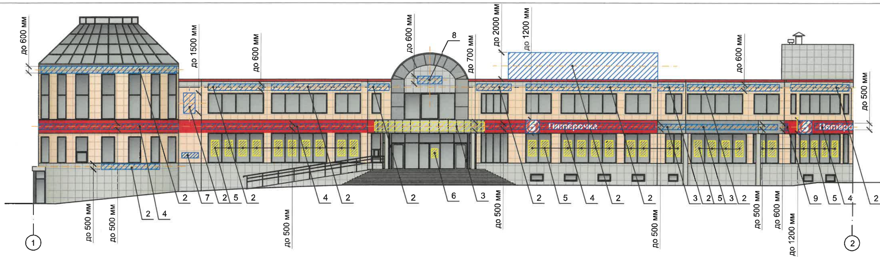
Схема компоновки объемных букв и/или логотипов, относительно оси и места размещения средств размещения информации, (поз.1)
