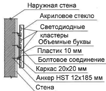
Узел крепления средств размещения информации (поз. 1)
