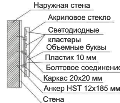
Узел крепления средств размещения информации (поз. 1)
