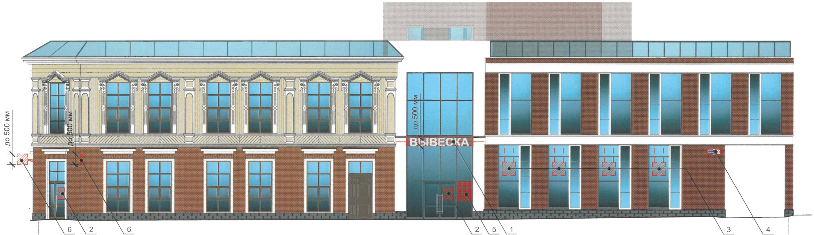
Схема компоновки объемных букв и/или логотипов, относительно оси и места размещения средств размещения информации
